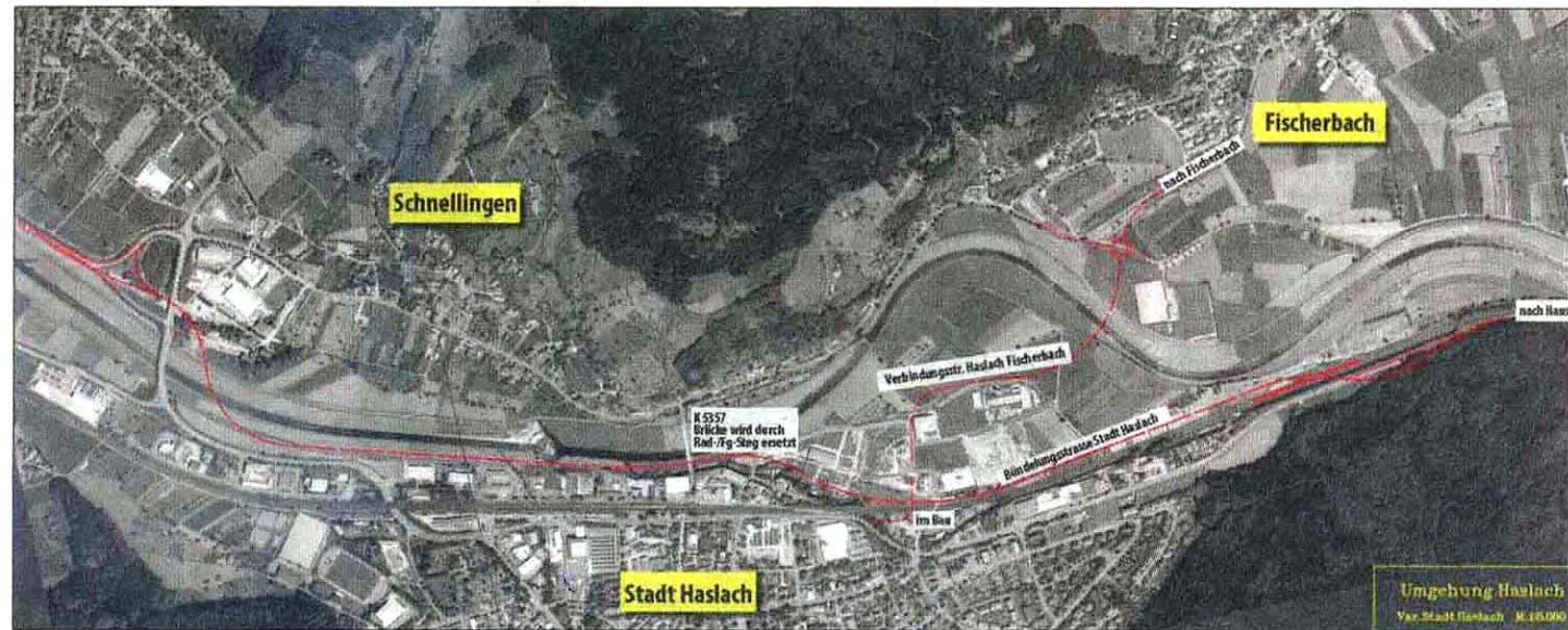
Die am Dienstag vorgestellte Trasse einer B-33-Umfahrung Haslachs: In Rot ist die neue Straße zu erkennen, die kurz nach der Bollenbacher Brücke auf die Südseite der Kinzig geleitet wird und dann mit der Schwarzwaldbahn gebündelt weitergeführt wird. Rechts ist auch die neue Verbindungsstraße nach Fischerbach angedeutet.
